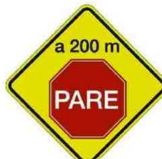
Proximidad de Señal Restrictiva (Pare)
