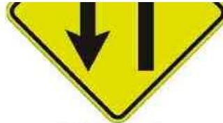
Inicio de Doble Circulación
